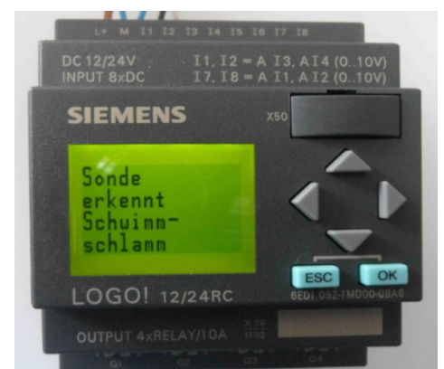
Sonde hat Schwimmschlamm erkannt
